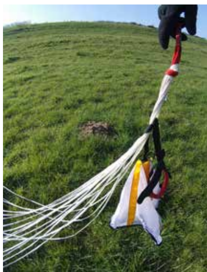
Poignée longue : un risque de s'enrouler autour du faisceau de suspente lors de du lancer du pod.
